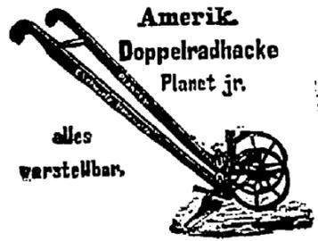
Fig. 17. Gewicht 8,5 Ko. Preis 32 Mk. Tägliche Arbeitsleistung durch eine Person 1 1/2-2 Morgen; ausgestattet mit den Häufelschaaren, auch vortrefflich zum Häufeln von Sechswochen-Kartoffeln. Zu beziehen vom Generalvertreter und Engroslager für Berlin und Umgebung **E. Schwartz, Marienfelde.**
