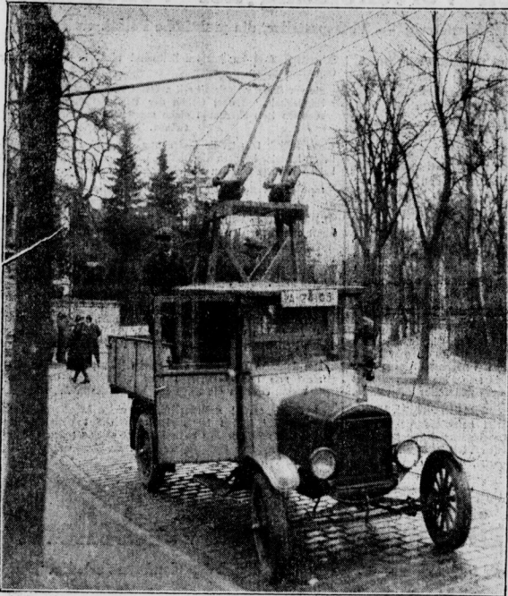
In Lichtenfeld-Ost werden mit einem Wagen, den man auch schienenlose Strassenbahn nennen kann, Versuche angestellt
