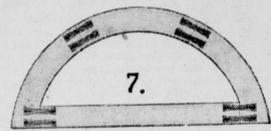
Bohrhammer, womit das Loch vorgebohrt wird, in den Handel. Man nimmt zunächst einen Schlangbohrer, bohrt das Loch, so tief es gebraucht wird; dann wird mittels der Bohrkönige, welcher für Hand und Maschine eingerichtet ist, das Loch nach hinten erweitert, also konisch. (Abbildung 7.) In dieses Loch steckt man den mit Keilen versehenen Dübel, presst die Teile zusammen, so dass sich das Ganze von selbst verklebt.
