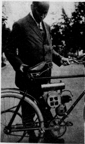
Ein neuer Fahrradmotor von 0,5 PS. Der nur 7 kg schwere Motor ist ohne große Veränderungen an jedem Rad an- zubringen, arbeitet wirtschaftlich und ist verhältnismäßig billig zu erwerben
