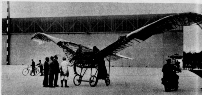
Der Ellenthalsche Schwingenflieger bei der Montage auf dem Tempelhofer Feld in Berlin Das Gesamtgewicht des Apparates beträgt 430 kg, die Spannweite 15 m, die Betriebskraft der Flügel 3 P. S.
